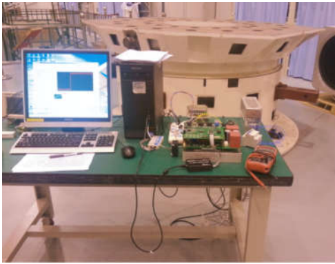
图 7 2 m 望远镜方位轴控制系统
